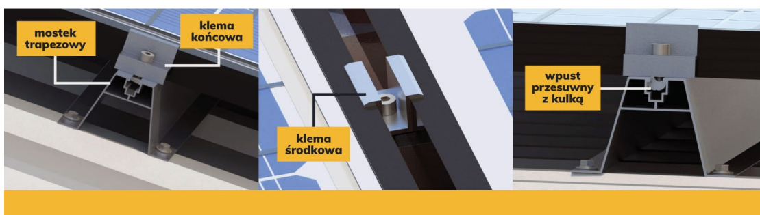
Sposób mocowania paneli do dachu z blachy trapezowej.
